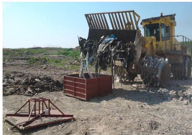
9. ábra: A TSZH hőtani paramétereinek mérésére kifejlesztett mérőberendezés.
